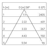
LED 3000 K 16,5 W 1821 lm-h 58° / CIE Flux 99 100 100 100 100 / A80 selon DIN 50...
