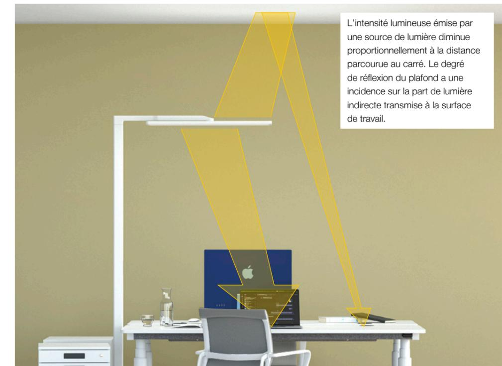
Lorsque la lumière tierce augmente, la commande EDR brevetée règle d'abord uniquement la lumière indirecte. Ce n'est qu'après que la part de lumière directe est, elle aussi, réglée. Cette régulation asynchrone de la lumière apporte une économie d'énergie significative par rapport à une commande d'éclairage à régulation synchrone tout en tenant compte de l'ambiance de la pièce.
