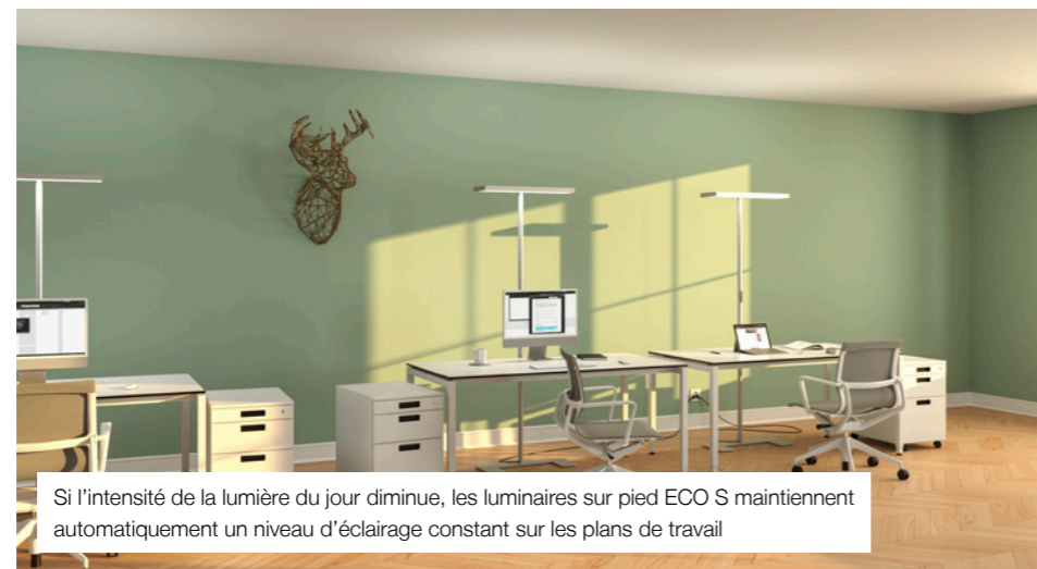
Les situations offrant beaucoup de lumière naturelle ne nécessitent qu'un minimum d'éclairage artificiel
