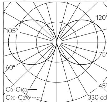
LED 4000 K 17.3 W 2469 lm-h / CIE Flux 13 37 66 50 100 / C11 nach DIN 5040
