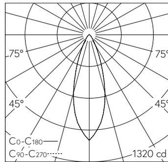
LED 4000 K 9.2 W 467 lm-h / CIE Flux 91 98 100 99 100 / A80 nach DIN 5040
